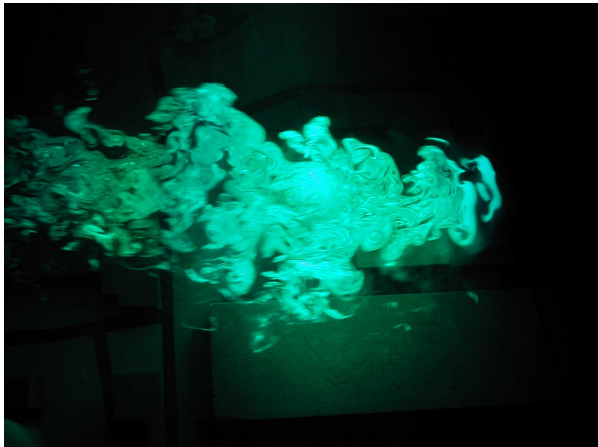
FIG.: Visualisation de la turbulence. Écoulement dans la soufflerie de l'École centrale de Lyon autour de la maquette de la centrale nucléaire du Bugey. Crédit : École centrale de Lyon et Institut de radioprotection et de sûreté nucléaire (Olivier Isnard).
