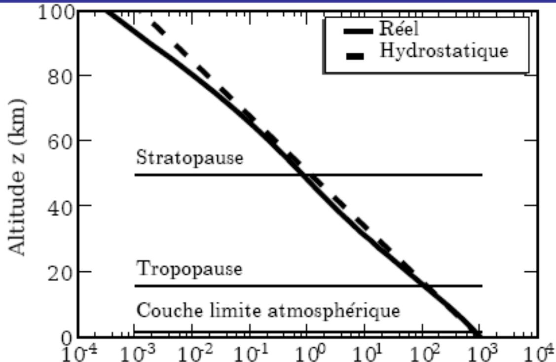
Profil vertical de pression (atmosphère standard USA 1976) calculée avec  $H=7.3$  km ( $T_{sol} = 250K$   $P_{sol} = 1000$  hPa)
