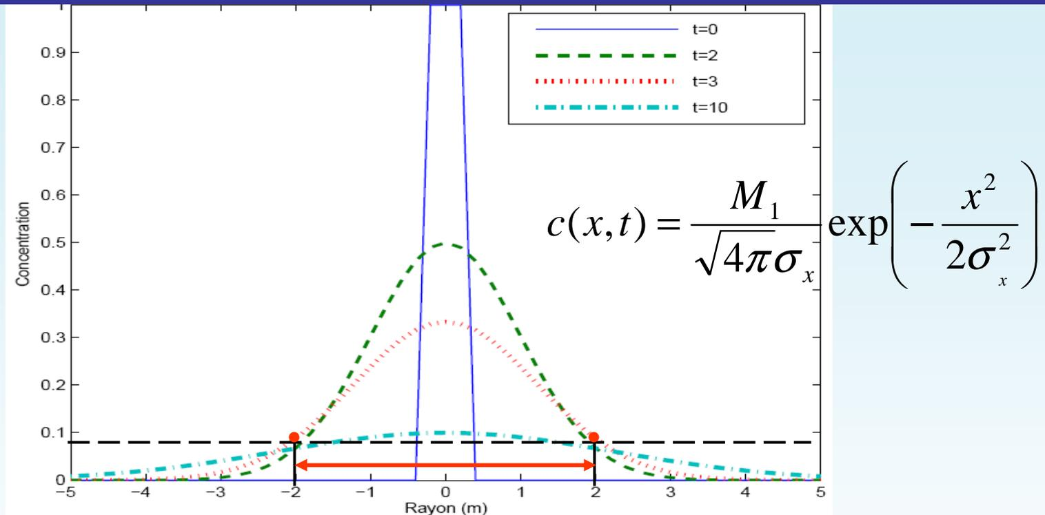
**Evolution de la répartition de la concentration  $c(x,t)$  pour une masse injectée instantanément en  $x=0$  dans un milieu au repos**
