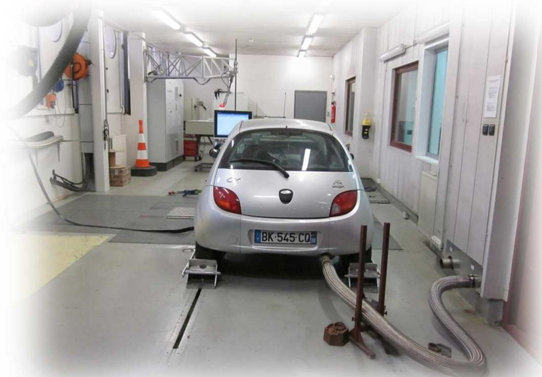
Les facteurs d'émissions des véhicules sont obtenus sur banc d'essai, par exemple à l'Institut français des sciences et technologies des transports, des aménagements et des réseaux (Ifsttar). Le véhicule suit un cycle de conduite et les émissions de certains polluants sont mesurées à la sortie du pot d'échappement après dilution.
