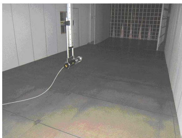
FIG. 9.5 – Veine de retour de la soufflerie « Malavard » (España et al. , 2008).
