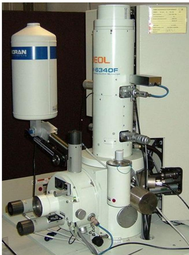
FIGURE 3.9 – Microscope électronique à balayage
